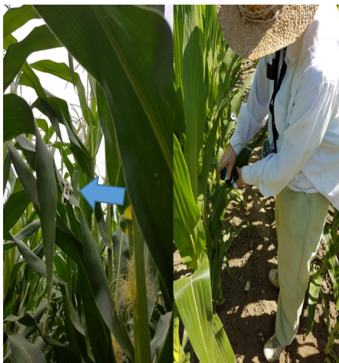
Slika 2. Štipaljka za adaptaciju na tamu na listu na klipu cvatuće biljke kukuruza (lijevo) i mjerenje fluorescencije klorofija a u polju ručnim fluorometrom (desno) (foto: Vlatko Galić).
